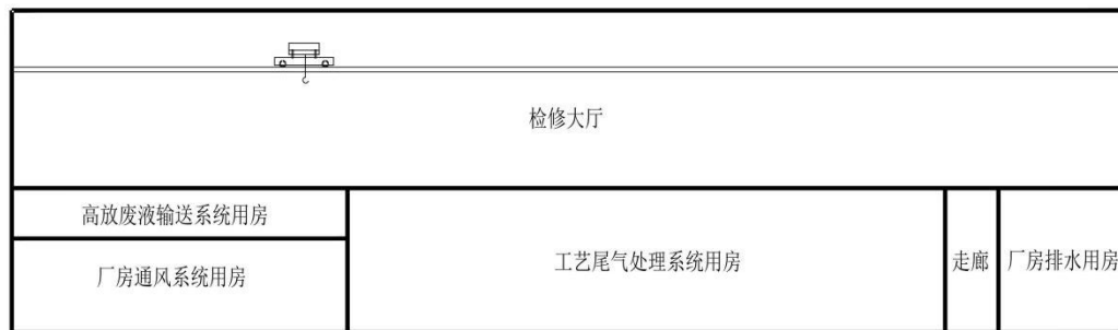
图 5 高放废液贮存厂房剖面图
