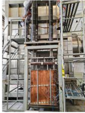
图 8 安装中的量热靶
