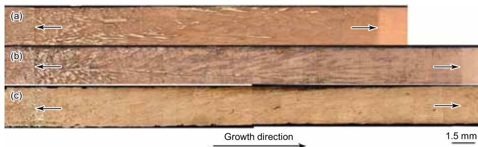
图 1 定向凝固 Al-12%Ni 合金在不同生长速率下的宏观组织
