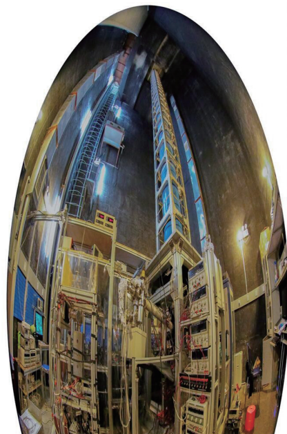
图4 十米喷泉式原子干涉仪（实际高度为12m）
